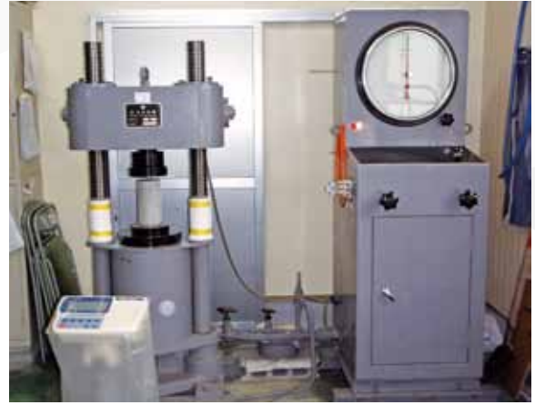
試験室（圧縮強度試験）
